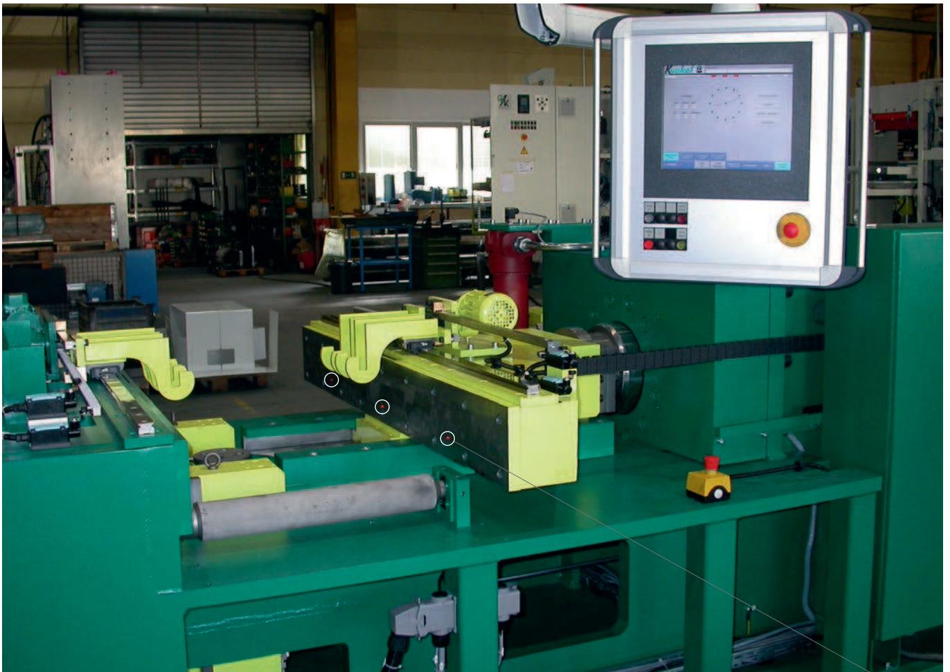
Industrie PC mit Kraft-Wege-Aufzeichnung / Industrial PC with motor-way recording with Laser measuring points
