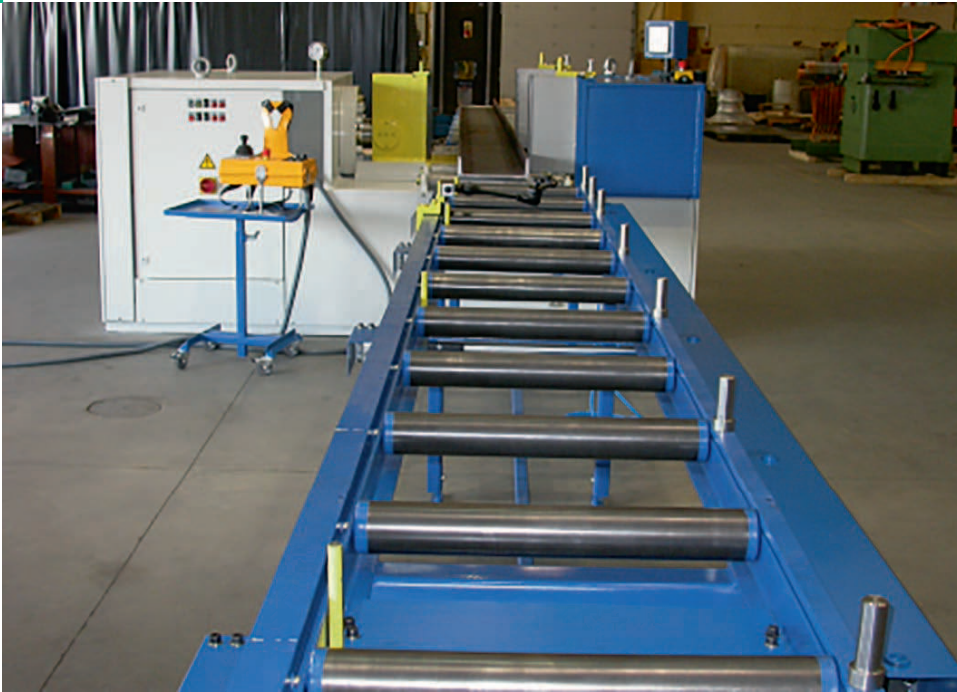
Universelle Richt- und Biegepresse mit Messtaster und externer Messvorrichtung sowie Rollgang Universal straightening and bending press with tactile measuring and external measurement device and roller conveyor
