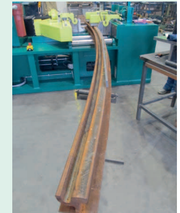
Vermessen des Kurvenverlaufs (Schiendurchbiegung) mittels Laser Measurement of the curve (Rail deflection) by laser
