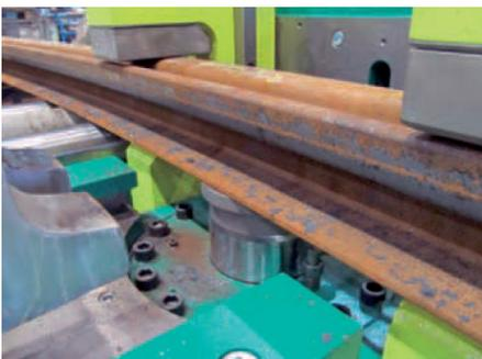
Hydraulikzylinder vertikal mit Niederhaltern
