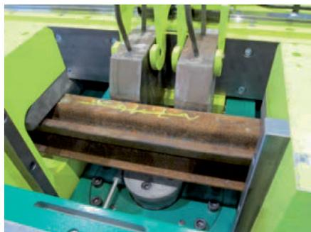
Hydraulikzylinder mit Druckstücken
